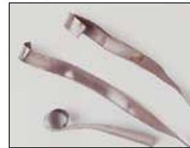
Zu lang - Bruchgefahr für das Werkzeug
