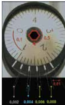
0,01 mm Skalenscheibe mit 0,002 mm Noniuskala
